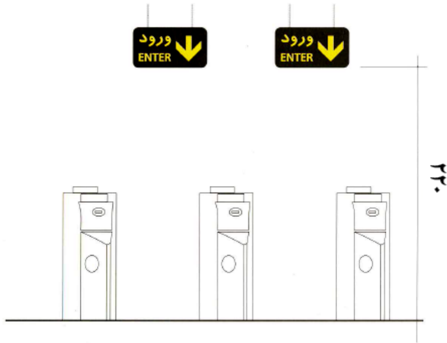
شکل ۱۲-۷ جزئیات نحوه نصب تابلو ورود
