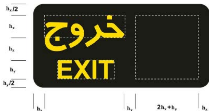
شکل ۳-۳ نحوه قرارگیری و اندازه‌های پیکان داخل تابلو
