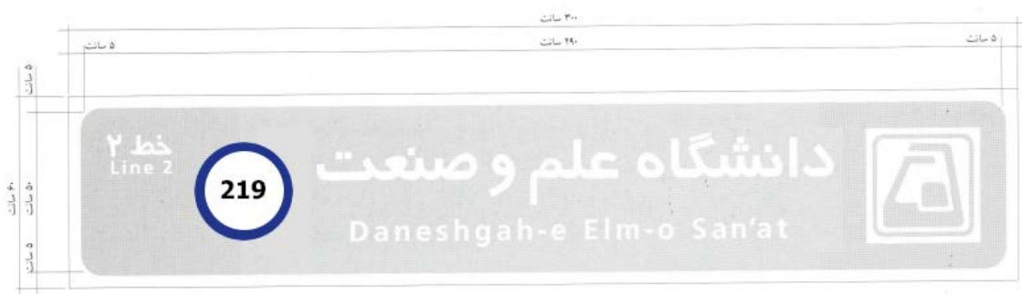
شکل ۴-۴ نحوه طراحی تابلو ورودی ایستگاه
