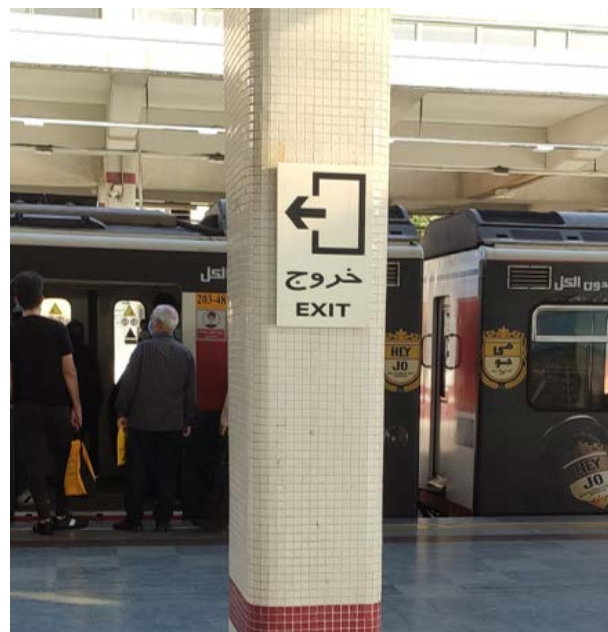
شکل ۸-۱۸ نمونه تابلو خروج اضطراری
